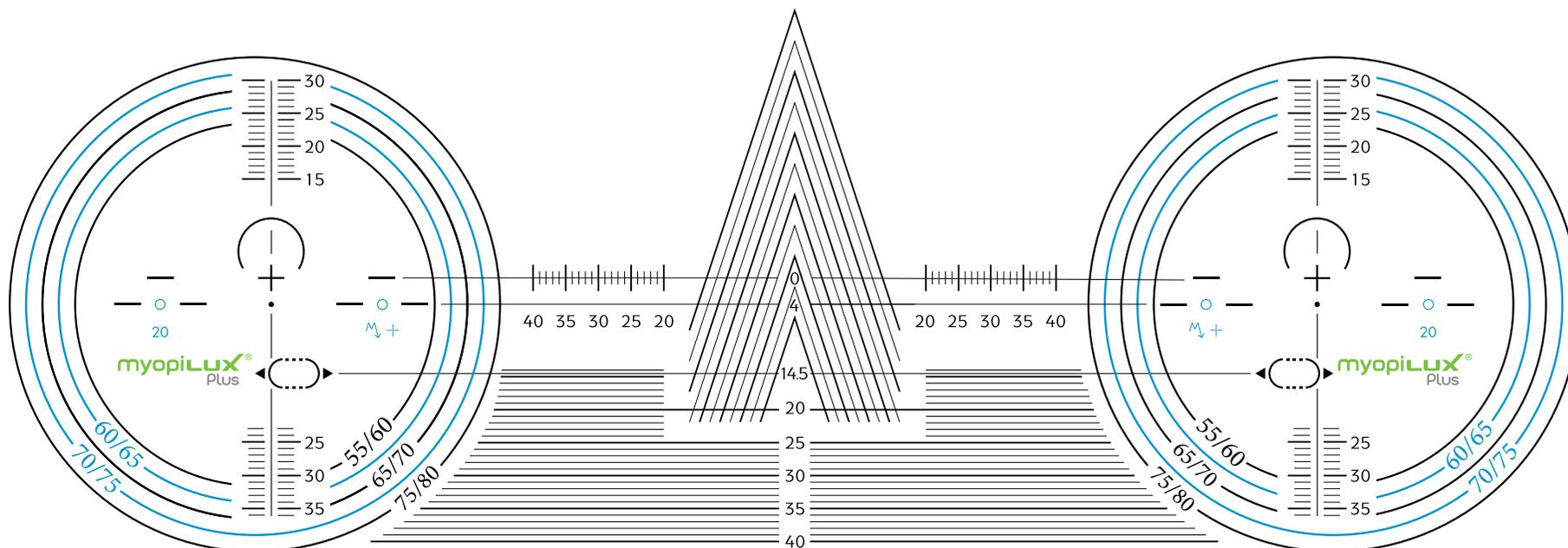
Зона ближнего зрения для MyopiLux Plus указана схематично. Допускается при монтаже линз срезать часть зоны разметки ближнего зрения. Установочная высота – не менее 14.5 мм.
